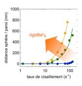
Schéma de la déformation de surface provoquant la portance élastohydrodynamique (à gauche). L'amplitude de cette portance, qui dépend de la force de l'écoulement, est d'autant plus grande que la couche déformable est molle (à droite).
