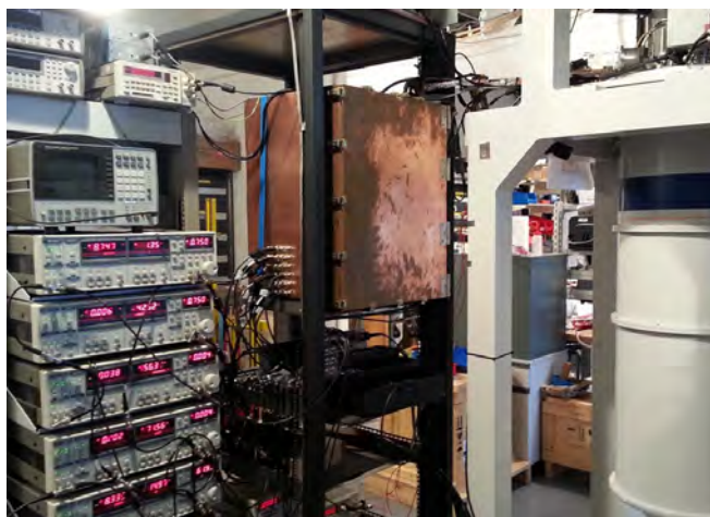
Photo du « réfrigérateur à dilution », le dispositif expérimental dans lequel a été installé et mesuré le circuit micrométrique. © Frédéric Pierre (C2N, CNRS/UPSud/Univ. Paris Saclay)
