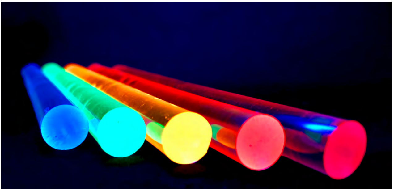
Photographie de tubes de plexiglass recouverts de solution de nanocristaux de différentes couleurs sous illumination UV @ LHULLIER et GREBOVAL : INSP, CNRS.
