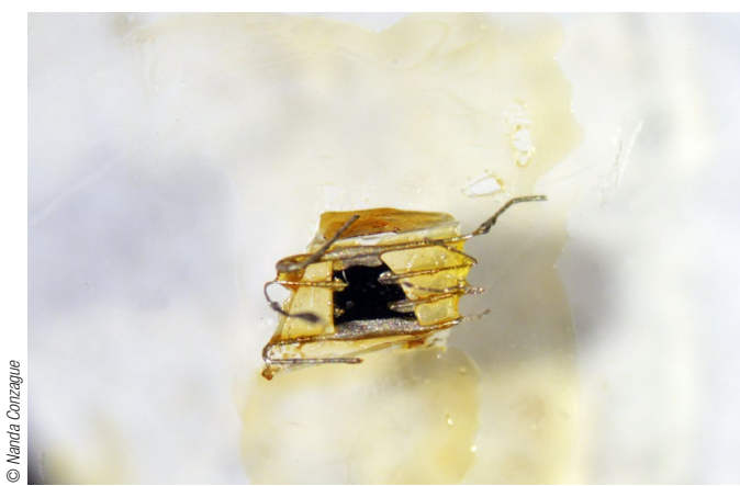
Photo prise sous microscope d'un mono-cristal de YBaCuO sur lequel sont collés cinq contacts électriques permettant d'effectuer des mesures d'effet Hall.
