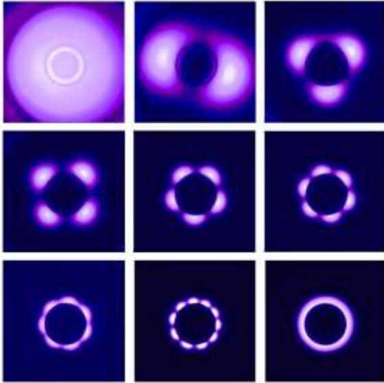
Intensité de l'émission lumineuse du plasma dans une source radiofréquence annulaire pour des pressions augmentant de gauche à droite et de haut en bas (de 0.2 à 300 Pa). Des modulations périodiques dans la direction azimutale sont observées lorsque la pression augmente.
