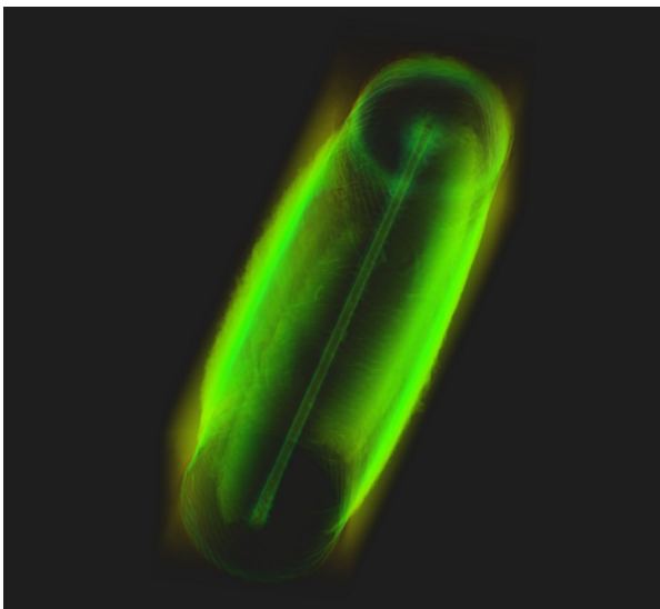
Tomographie par rayons X reconstruite d'un canal d'eau de 81 µm de diamètre à l'intérieur d'un ferrofluide. Les deux surfaces vertes marquent les limites intérieures et extérieures du ferrofluide.
