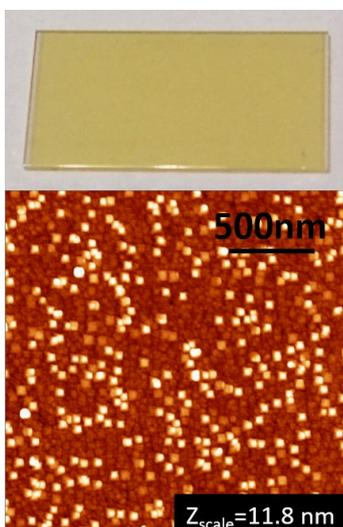
En haut : photographie d'un échantillon de MgO/Mg<sub>3</sub>N<sub>2</sub>/MgO sur un substrat de MgO (10x20 mm<sup>2</sup>) monocristallin.
